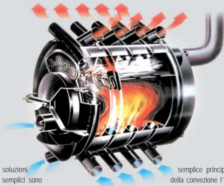
Le soluzioni più semplici sono spesso le migliori. La stufa **Bullerjan®** ne è la dimostrazione. E' composta da tubi di acciaio piegati che formano una camera di combustione cilindrica. La maggior parte della superficie si trova così all'interno della camera di combustione. Ciò garantisce un massimo scambio di calore.
